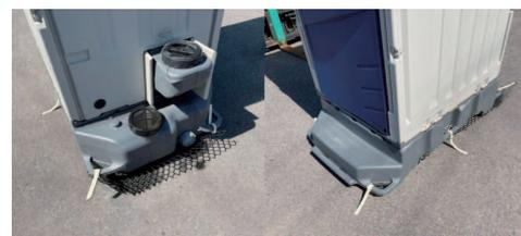
タンクグリップにネットをタイラップで固定します。底面が直接地面に触れないため、タンク・ドレンキャップの保護ができます。また、ネットによる摩擦低減で、トイレの移動が容易。
