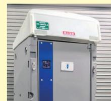
移動時は、ルーフを下げることで道交法における軽トラックの高さ制限を遵守。移動時の扉開閉防止にもなります。
